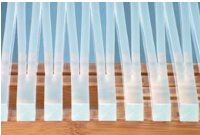
Wie eine „Ziehharmonika“ lässt sich der Mittelteil des Tisches auseinander ziehen. Hier ein Prototyp aus Plexiglas, das mit Laser geschnitten wurde
